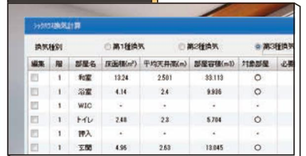
シックハウス換気計算書作成機能。計画換気量を入力し、適合しているかどうかの判定を行い、設計図書出力します。
