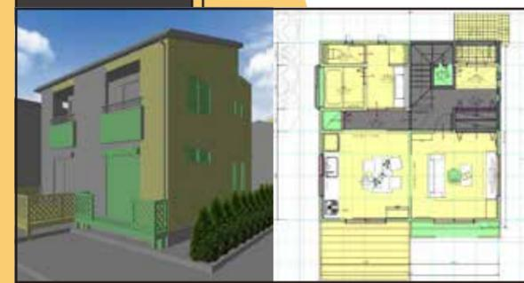
リフォーム対象部位を『既存・改築・増築』別にパースや図面で色分け表示できます。部屋単位だけでなく建具・設備・外壁・屋根など、独立した指示ができます。また、『既存・改築・増築』ごとの積算数量を自動算出・CSV出力できることでより正確なリフォーム積算ができます。
