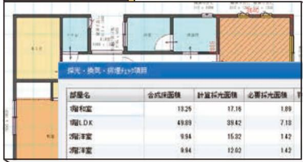
敷地境界の入力、用途地域の設定を行うことにより、建築物の確認申請レベルの採光および換気に対する建築計画のチェックを行うことができます。
