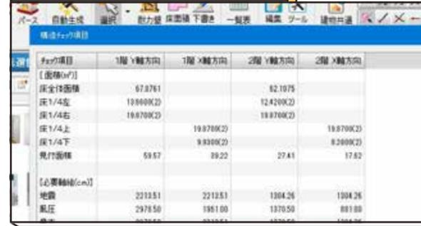
地震力・風圧力に対する壁量のチェックが行なえます。あらかじめ、通し柱・隅柱・管柱などを入力しておくことで、耐力壁の自動配置も行えます。また、耐力壁入力後、かすがい、羽子板ボルト、ホールダウン金物など金物類の自動配置も行えます。
