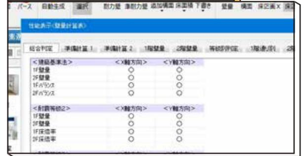
入力されたプランをもとに、伏図の有無に関わらず、木造軸組2階建て(延べ床面積500㎡)までの住宅性能表示レベルの構造の安定に関する壁量と床倍率のチェックが行なえます。
