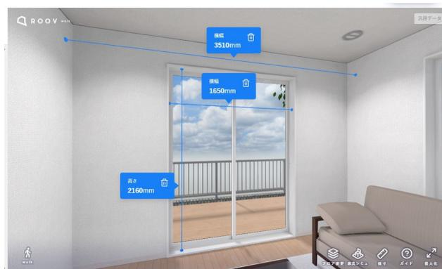
2点間の距離を測定することができます。お施主様が間取りを測定して、手持ちの家具が設置できるか確認することが可能。
